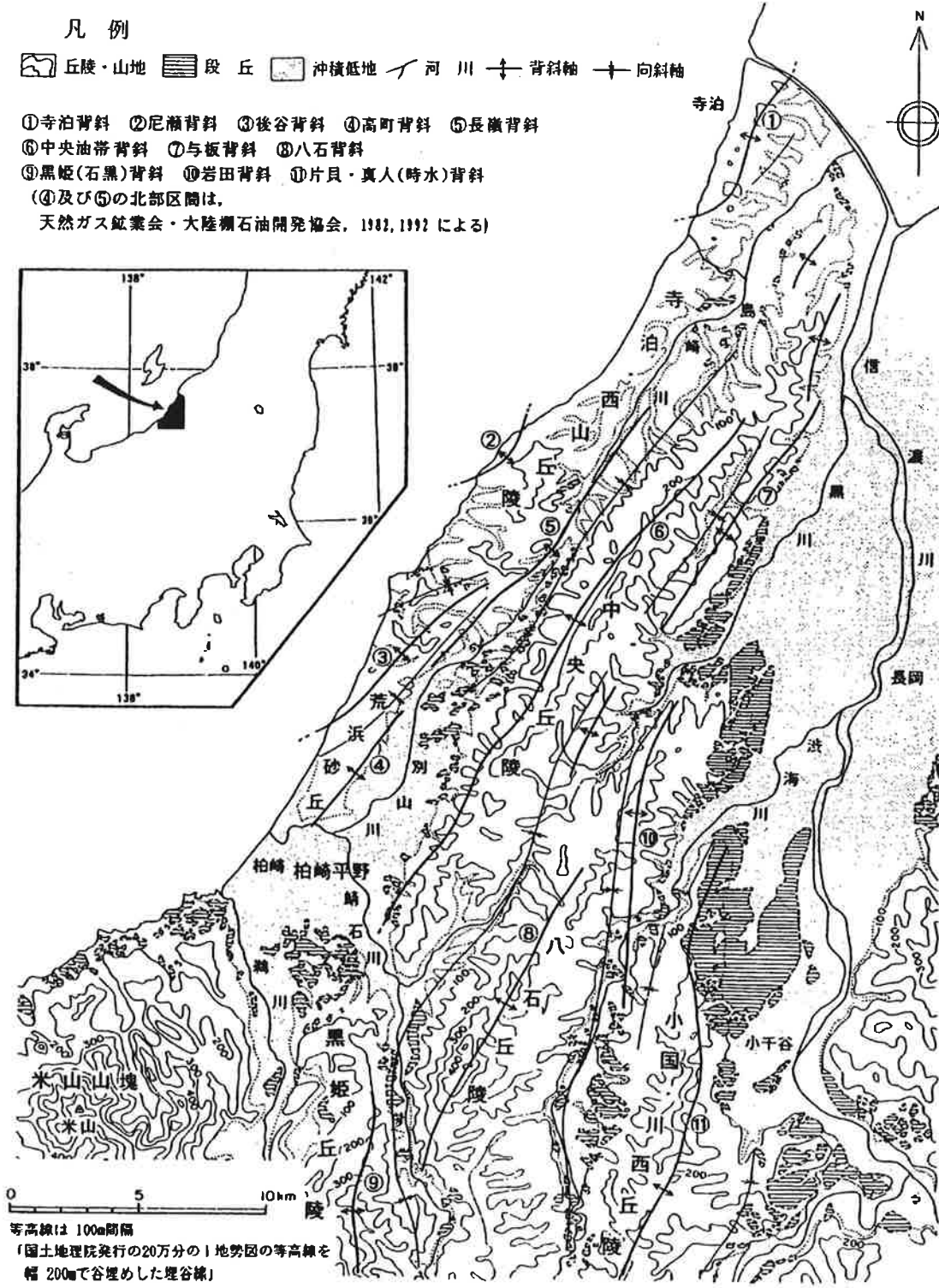
図3-3-1 柏崎平野及びその周辺地域における地形・地質構造の概要 岸他, 新潟県柏崎平野周辺における鮮新世~更新世の褶曲形成史 地学雑誌 Jor.Geo.1996
